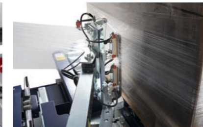
Système automatique de pince, coupe et enduction film (ou soudure film en opt.) Automatisches Greifer-, Folienschnitt- und -anlegesystem (CS) (oder Schweißsystem opt.)
