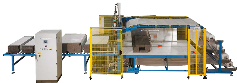
STRETCHPACK 130 S Macchina automatica con caricamento manuale dei prodotti. Automatic machine with manual products loading.
